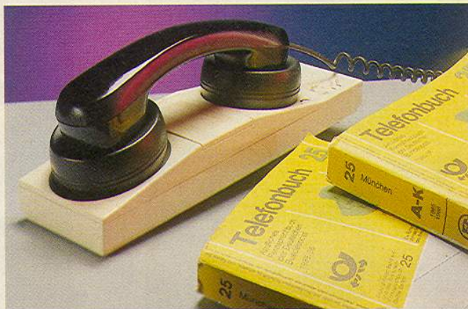
6 Mit einem Akustikkoppler lassen sich zwei Computer über eine Telefonleitung miteinander verbinden
