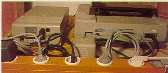
2 Unterbringung der Netzstecker auf einer Steckerleiste
