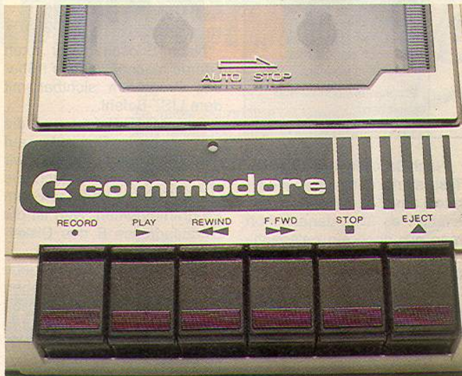
3 Die Datasette hat sechs Tasten zum Laden und Speichern von Programmen und Vor- und Rückspulen der Kassette
